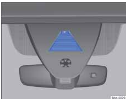
图 173 前车窗：车道保持系统摄像头视窗
