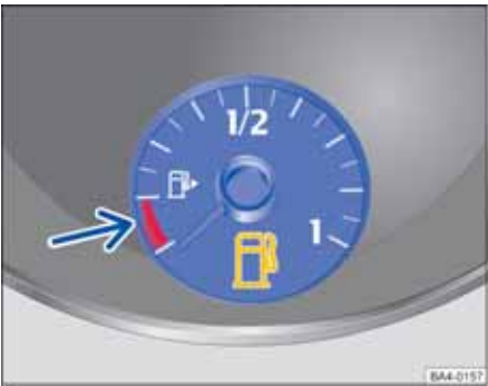
图 193 在中：汽油的备用油指示。
