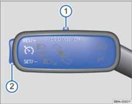
图 160 转向柱左侧：定速巡航系统操作开关及按钮
