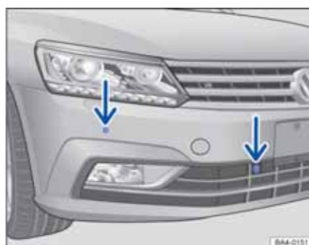
图 148 右前保险杠上智能泊车辅助系统的传感器和驻车距离报警系统的传感器
