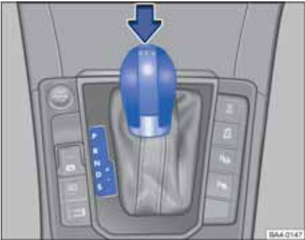
图 126 带锁止按钮（箭头所示）的自动变速箱换挡杆。
