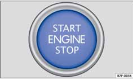
图 121 无钥匙系统 Kessy：中控台下部分中的启动按钮。
