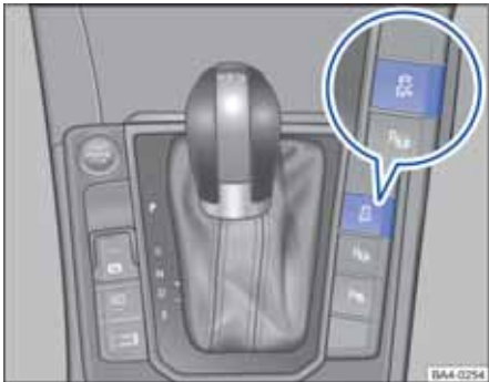
图 129 在中控台中：用于手动关闭和接通牵引力控制系统（ASR）的按钮。
