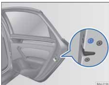
图 216 左侧后车门端面处的应急上锁装置（由橡胶密封件遮盖着）
