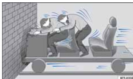
图 67 载有未系安全带的驾乘人员的汽车撞到墙上
