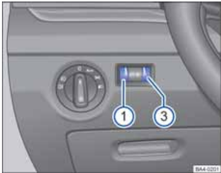
图 88 在方向盘旁边：仪表和开关照明的调节器①以及环境照明灯（氛围灯）亮度调节③（部分车型）
