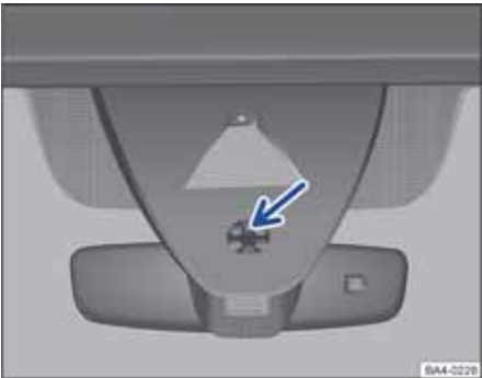
图 95 雨量传感器的传感表面。
