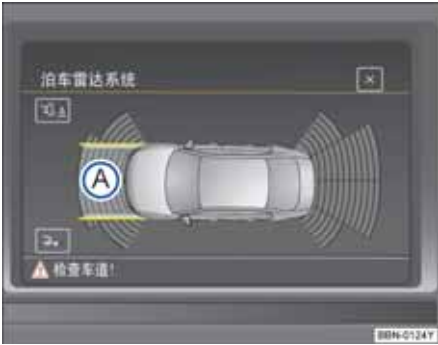
图 138 驻车距离警报系统显示屏：未施加转向时轿车行驶路径显示模式
