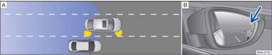
图 177 原理图：(A)：超车和并道的行驶状况。(B)：右侧车外后视镜上的盲区监控传感器显示
