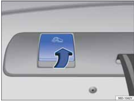
图 83 Top Tether 固定点
