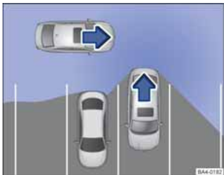
图 178 驶出车位辅助原理图：车辆驶出停车位时的四周监控范围
