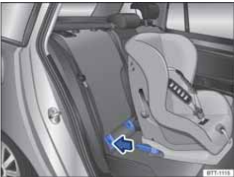
图 82 原理图：安装带固定臂的 ISOFIX 儿童座椅
