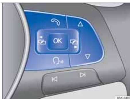
图 16 多功能方向盘右侧：用于操作组合仪表中的菜单和信息显示的按键
