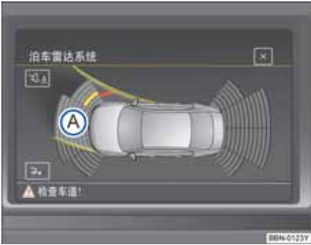
图 139 驻车距离警报系统显示屏：施加转向时轿车行驶路径显示模式
