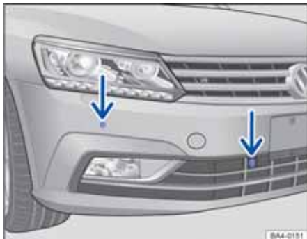
图 156 右前保险杠上智能泊车辅助系统的传感器和驻车距离报警系统的传感器
